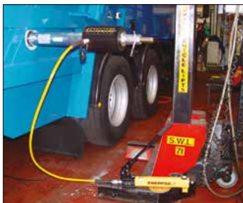
◀ Urządzenie RACH306, napędzane pompą ręczną P392, służy do wyciągania skorodowanych czopów karoseryjnych z zełmowanych samochodów.
