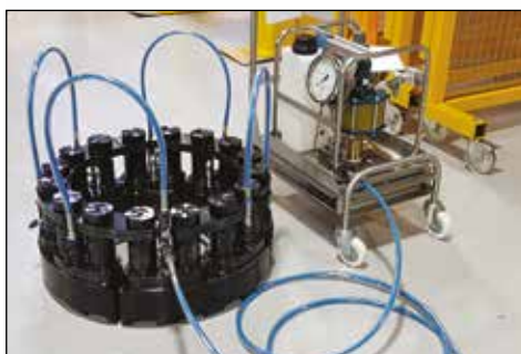
◀ System napinania do układów wielośrubowych (MST) firmy Enerpac umożliwiający jednoczesne napinanie wszystkich śrub dwustronnych w połączeniu.
