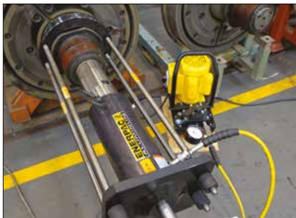
◀ Ciągnięcie koła szynowego za pomocą aluminiowego cylindra RACH napędzanego pompą serii ZE.
