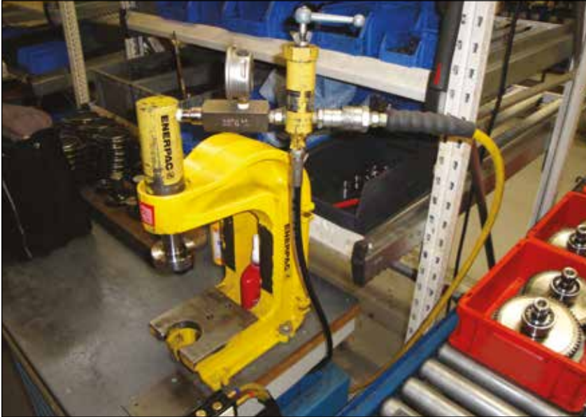
▲ Cylinder RC308 zamontowany na prasie montażowej A330 do wrzecion, zasilany pompą pneumatyczną PATG-Turbo, do kontrolowanego wprasowywania łożysk do kół łańcuchowych maszyn tkackich. Ciśnieniowy zawór bezpieczeństwa V152 steruje siłą prasowania.
