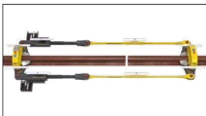
▲ Modułowe urządzenie 70-tonowe służące do naprężania i utrzymywania szyn w neutralnej pozycji wzdłużnej podczas procesu spawania.
