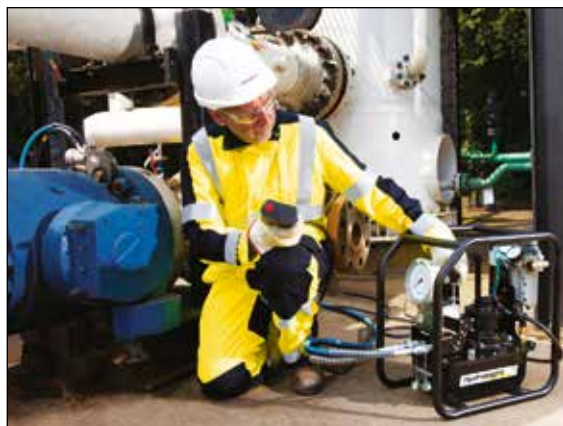
◀ Pompa do kluczy dynamometrycznych Enerpac Serii -ZA4T może zasilać większość hydraulicznych kluczy dynamometrycznych.
