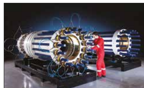
▲ Układ podwodnych napinaczy Enerpac z podłączonymi węzami serii HT podczas równoczesnego napinania śrub taką samą siłą
