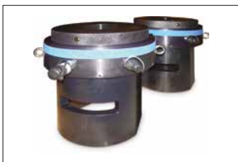
◀ Niestandardowe napinacze hydrauliczne do 5-calowych śrub dwustronnych o obciążeniu 4200 kN.
